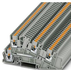
建筑安装用端子，标称工作电压: 400 V，标称工作电流: 24 A，直插式连接，额定接线容量: 4 mm<sup>2</sup>，横截面: 0.14 mm<sup>2</sup> - 4 mm<sup>2</sup>，直插式连接，额定接线容量: 1.5 mm<sup>2</sup>，横截面: 0.14 mm<sup>2</sup> - 4 mm<sup>2</sup>，安装方式: NS 35/7,5，NS 35/15，颜色: 灰色
