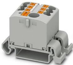
接线板，可以使用导体轴将端子块相互桥接，相应的插拔式桥接件请见附件，水平并列安装并带有内置电源的模块，标称工作电压: 690 V，标称工作电流: 24 A，接线方式: 直插式连接，负载触点，横截面:  $0.14 \text{ mm}^2 - 4 \text{ mm}^2$ ，直插式连接，线路触点，额定接线容量:  $6 \text{ mm}^2$ ，横截面:  $0.5 \text{ mm}^2 - 10 \text{ mm}^2$ ，安装方式: NS 35/7,5，NS 35/15，颜色: 灰色
