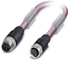
总线电缆，CANopen<sup>®</sup>，DeviceNet<sup>™</sup>，5-芯，PUR 无卤素，紫色 RAL 4001，屏蔽，插头 直头 M12，编码: A，与 孔式 直头 M12，编码: A，电缆长度: 1 m
