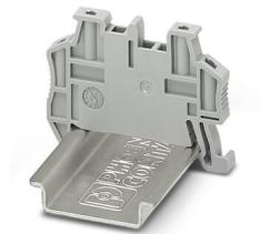
快装终端紧固件，用于NS 35/7.5 DIN导轨或NS 35/15 DIN导轨，带用于FBS...5、FBS...6、KSS 5、KSS 6的标记选项，宽度：5.15 mm，颜色：灰色
