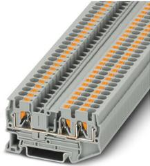
直通式接线端子，标称工作电压: 800 V，标称工作电流: 32 A，接线方式: 直插式连接，额定接线容量: 4 mm<sup>2</sup>，横截面: 0.2 mm<sup>2</sup> - 6 mm<sup>2</sup>，安装方式: NS 35/7,5，NS 35/15，颜色: 灰色
