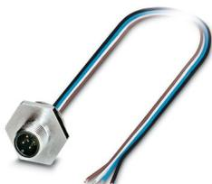
设备连接器 板前安装，通用，4-位置，直头，M12-标准，编码: A，与端自由出线，板前安装，M20 x 1,5，单线，电缆长度: 0.5 m，0.34 mm<sup>2</sup>，预制TPE绞合线
