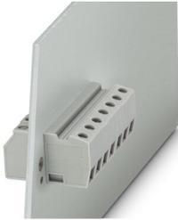
穿墙端子，接线方式: 带压片的螺钉连接，带压片的螺钉连接，位数: 1，负载电流: 32 A，横截面:  $0.2 \text{ mm}^2 - 6 \text{ mm}^2$ ，导线连接方向与拔插方向的夹角:  $0^\circ$ ，宽度: 8.1 mm
