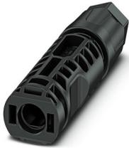
光伏插拔式连接器，产品范围: Sunclix，光伏连接器，外壳材料: PPE，颜色: 黑色，位数: 1，最小导线横截面: 2.5 mm<sup>2</sup>，最大导线横截面: 6 mm<sup>2</sup>，额定电压: 1500 V DC，额定电流: 40 A，连接方法: 压接，触点类型: 针式插头，最小电缆直径: 5 mm，最大电缆直径: 8 mm
