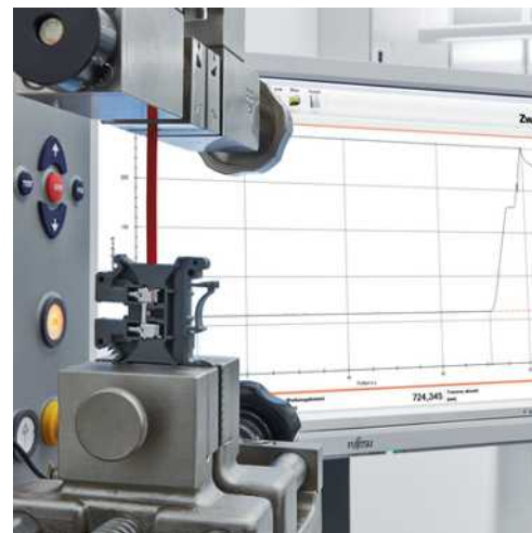
6 mm²接线螺钉端子的拉力吸收
