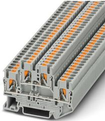
双层接线端子，标称工作电压: 500 V，标称工作电流: 22 A，接线方式: 直插式连接，第一和第二层，额定接线容量: 2.5 mm<sup>2</sup>，横截面: 0.14 mm<sup>2</sup> - 4 mm<sup>2</sup>，安装方式: NS 35/7,5，NS 35/15，颜色: 灰色
